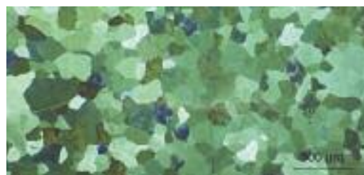
(d) Fe-16Mn-0.6C TWIP steel with 1.5wt%Cu
